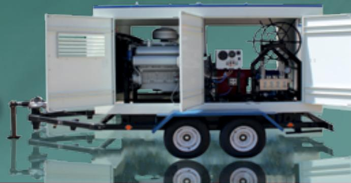
**Завод «Байкал»** разработал специальное предложение для наших Заказчиков: мобильные автономные гидродинамические установки высокого давления на малогабаритном низкорамном прицепе.
