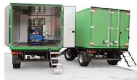
Установка НВД 90 УНГ2 от электропривода установленная на прицепе
